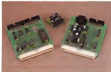
L'intero delle due interfacce: rispettivamente SDI (parallelo) e SDA (seriale) e l'espansione di memoria di 256 Kbyte.
